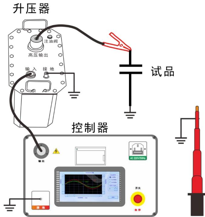
图 7 试验接线图
