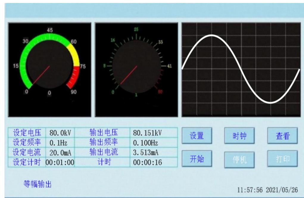
图 9 等幅输出示意图
