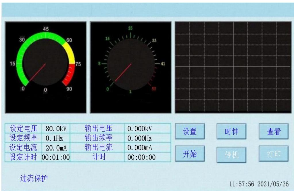
图 13 过流保护示意图
