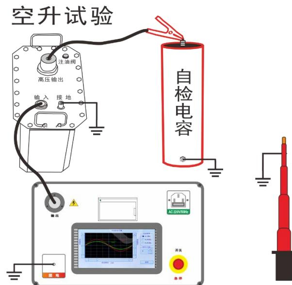
图 17 仪器空升自检接线示意图
