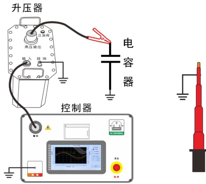
图 16 电力电容器试验接线示意图
